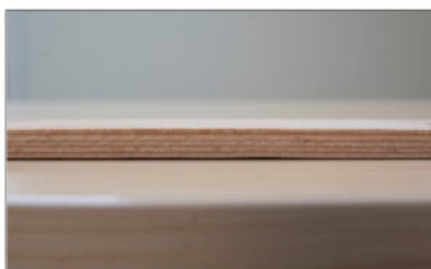
Vyroben z pěti vrstev BK dýhových odřezků či dýhových listů a ze dvou vrstev skelné tkaniny
