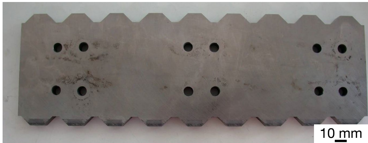
Nůž a lokality s vylomeným a prasklým ostřím
