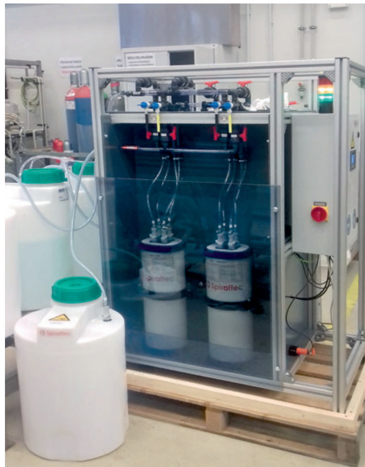
Použitá pilotní jednotka difúzní dialýzy obsahující dva spirálně vinuté moduly Spiraltec pro regeneraci kyselin. Pilotní jednotka zpracuje cca 450 kg kyseliny za 24 h provozu.
