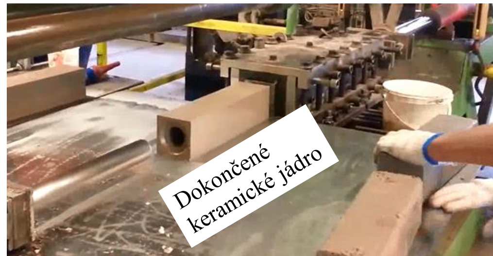
Obr. 5. Ve 4 cyklech s celkem 14ti operacemi vzniká keramické jádro.
